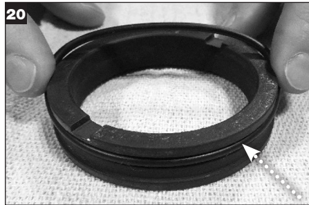
20 回転O-リング(W) にホワイトグリースを薄く塗布し、アウトボード回転環外径の上にある溝に取付けます。
