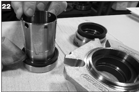
22 部品の最終組立に移る前に、清潔な布と認可された溶剤を使用してシール表面を洗浄します。
