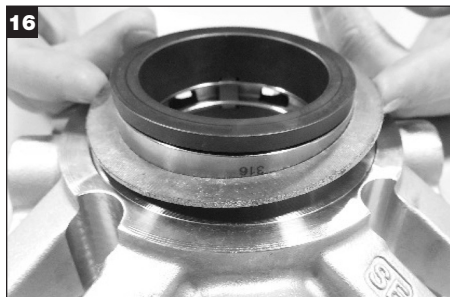
16 アダプターからガスケットを外し、廃棄します。
