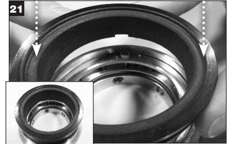
21 回転環内の駆動スロットとフォロワーラグの位置を合わせます。回転環を静かに押してロックリング内に固定します。注意：駆動チューブを押し込まないでください。
