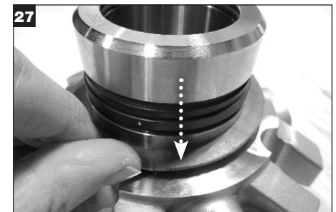
27 スタッフィングボックスガスケットをグランドの凹部に取付けます。
