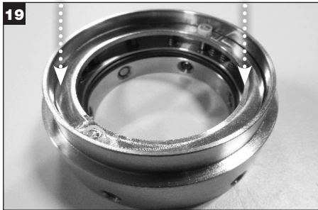
19 フォロワーアセンブリ内のピンとロックリング内のマークされた穴の位置を合わせ、正しい位置に到達するまで押します。
