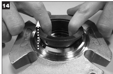
14 グランドからアウトボード固定環を外し、廃棄します。
